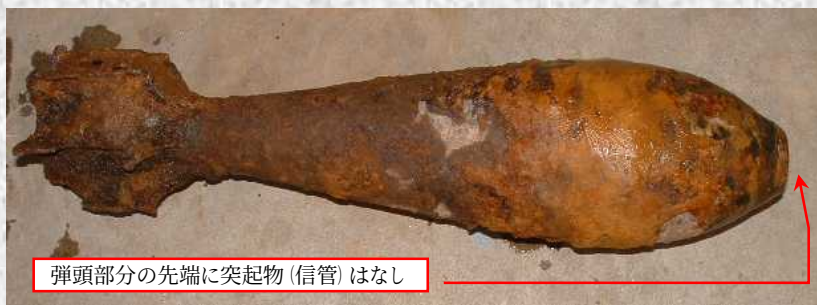
写真 平成 19 年に発見された毒ガス弾の可能性のある砲弾 （この砲弾には、弾を爆発させる信管がついていません。弾頭部に突起がある場合は信管が付いている可能性があり、衝撃を与えると爆発する危険性があります。） （写真提供：防衛省）
