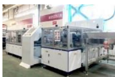
太陽光パネルリサイクル設備
